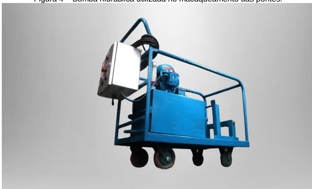
Figura 4 – Bomba hidráulica utilizada no macaqueamento das pontes.
