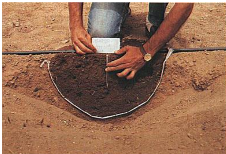
Figura 2.3 – Trincheira escavada em campo mostrando o bulbo molhado formado após uma irrigação por gotejamento Fonte: Rodrigo López et al. (1992)
