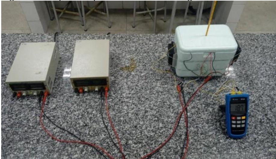
Figura 12 - Esquema experimental de uma mini geladeira
