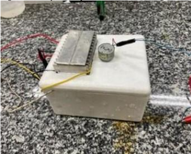
Figura 11 - Esquema experimental de um microgerador termoelétrico
