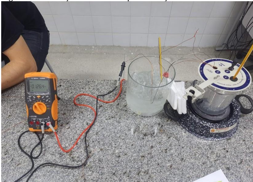
Figura 8 - Associação Única de fios para obtenção do efeito termoelétrico
