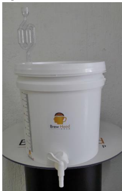
Figura 9 - modelo de fermentador utilizado com air-lock em “S” ao topo.
