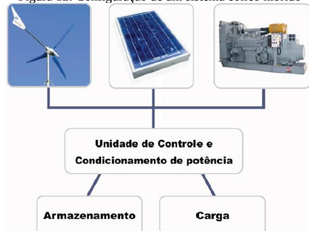
Figura 12: Configuração de um sistema eólico híbrido
