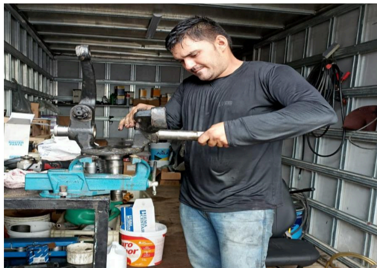
Figura 21 - Mecânico fazendo o reparo do embuchamento da manga de eixo
