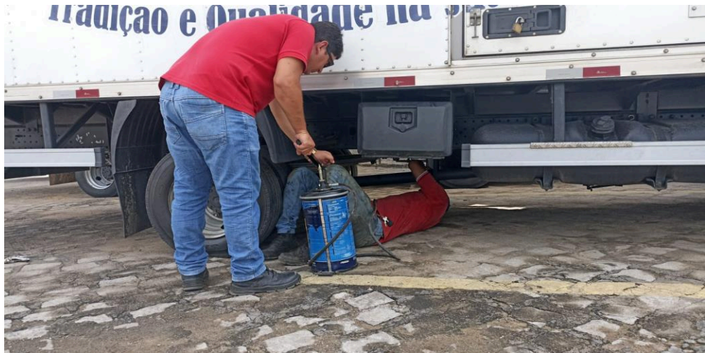
Figura 19 - Mecânico lubrificando o caminhão
