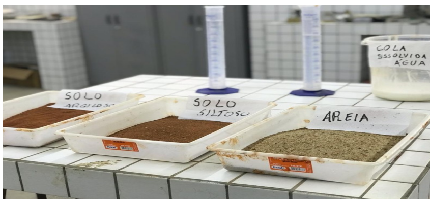
Figura 20. Separação dos materiais para o tijolo com adição de cola branca. (Autoria própria)
