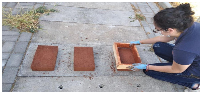
Figura 14. Moldagem dos tijolos. (Autoria própria)
