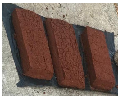
Figura 23. Secagem dos tijolos ao ar livre: a) Sem a lona e b) Com a lona. (Autoria própria)
