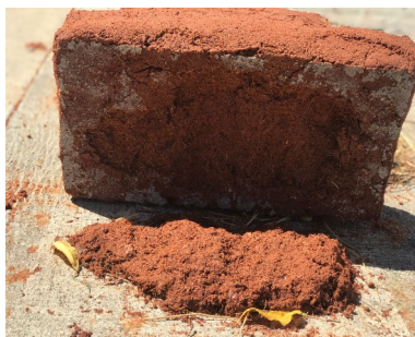
Figura 22. Tijolo com cola aderido ao chão. (Autoria própria)
