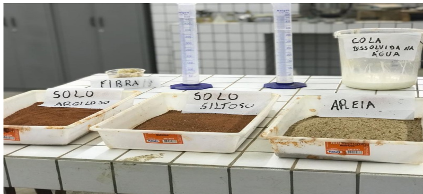
Figura 18. Separação dos materiais para o tijolo com adição de fibra e cola branca. (Autoria própria)
