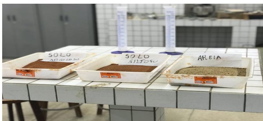
Figura 8. Separação dos materiais para o tijolo de referência. (Autoria própria)
