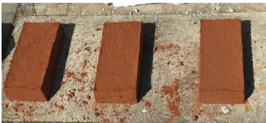
Figura 16. Secagem dos tijolos ao ar livre. (Autoria própria)
