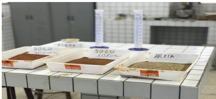
Figura 11. Separação dos materiais para confeccionar o tijolo com adição de fibra. (Autoria própria)
