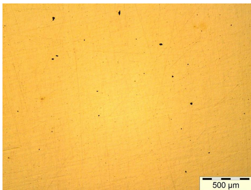
Figura 10 - Micrografia sem ataque das amostras temperadas.
