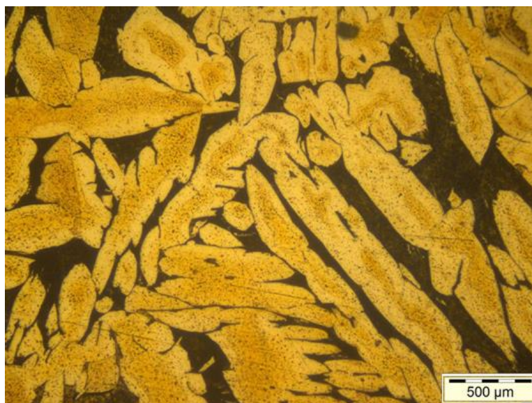
Figura 9 - Micrografia do lingote bruto de fusão pós-ataque.
