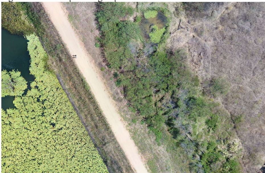
Figura 22 - Presença de vegetação excessiva
