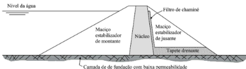
Figura 9 - Representação filtro chaminé e tapete drenante
