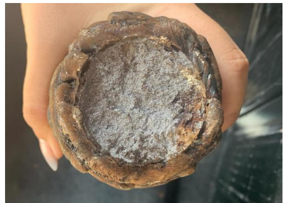
Figura 14- Superfície da fratura (Fonte: Autoria própria)
