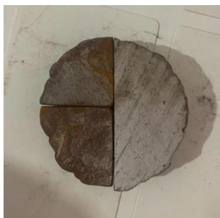
Figura 18- Seção retirada da parte soldada do eixo. (Fonte: Autoria Própria)
