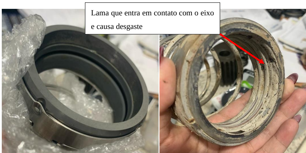
Figura 12- Selo Mecânico novo x Selo Mecânico desgastado. (Fonte: Autoria própria)
