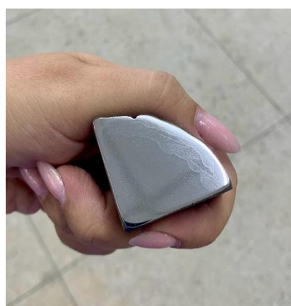
Figura 19- Amostra após o polimento. (Fonte: Autoria Própria)
