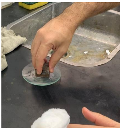
Figura 20- Ataque químico a amostra em Nital 2%. (Fonte: Autoria Própria)
