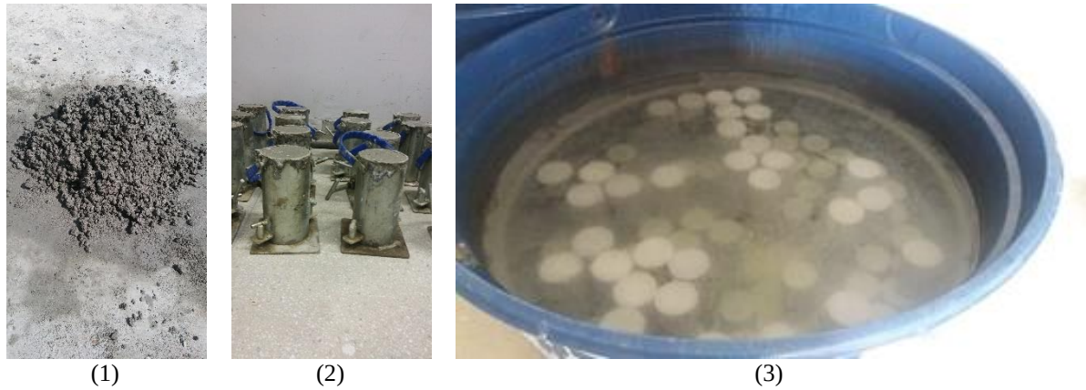
Figura 11 – Moldagem e cura dos corpos de prova: (1) Preparo do traço; (2) Corpos de prova moldados e (3) Cura.
