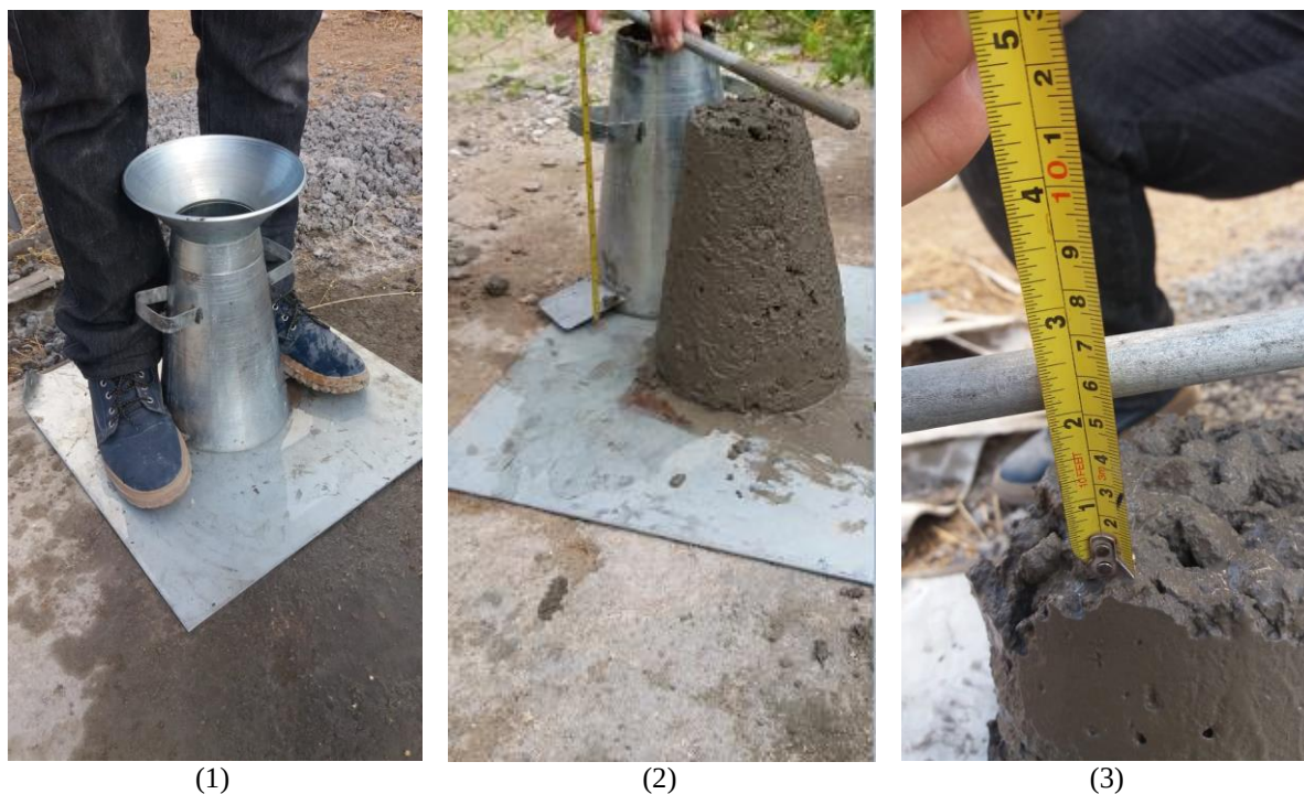
Figura 9 – Ensaio de abatimento com tronco de cone: (1) Equipamento montado com pés sobre as aletas; (2) Amostra assentada ao lado do molde e (3) Determinação das medidas de diferença de altura.
