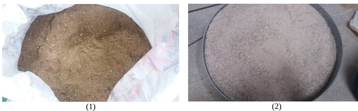
Figura 3 – Agregados miúdos utilizados: (1) Areia natural e (2) pó de pedra.
