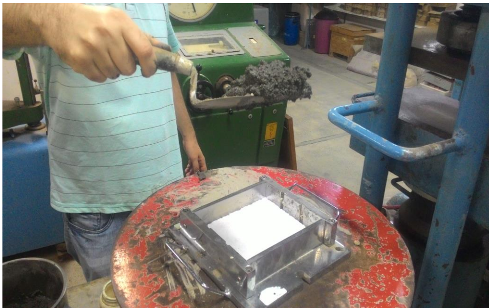
Figura 20 - Ensaio da eflorescência – moldagem dos CP's
