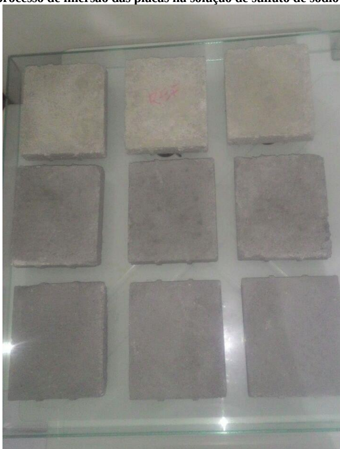
Figura 27 - Início do processo de imersão das placas na solução de sulfato de sódio
