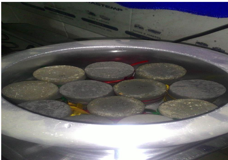
Figura 19 - Ensaio de absorção por imersão em água – Corpos-de-prova na ebulição por 5h
