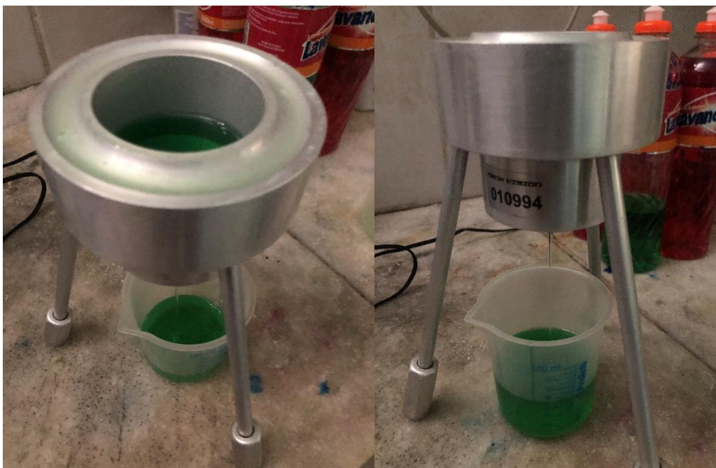
Figura 9 - Determinação da viscosidade do lava-louças limão utilizando o copo ford
