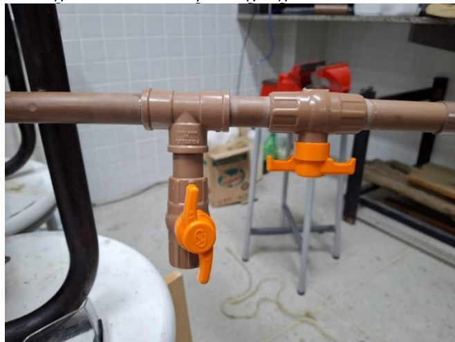
Figura 11 - Válvulas para regulação ar/combustível.
