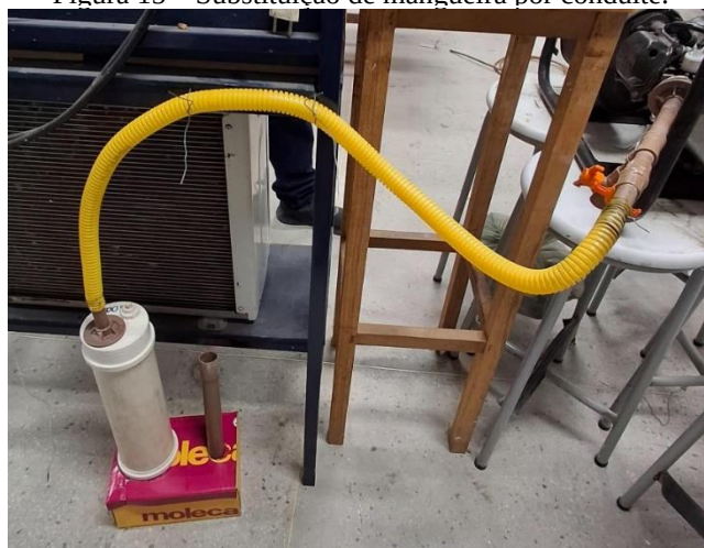
Figura 15 – Substituição de mangueira por conduíte.
