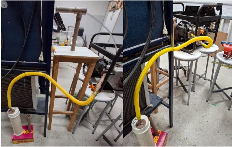
Figura 16 - Aparato para geração do vapor de gasolina.
