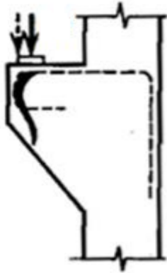
Figura 6 - Ruptura por Falha de Ancoragem
