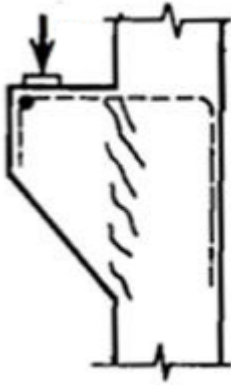
Figura 5 - Ruptura por Cisalhamento
