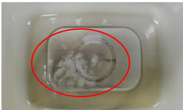
Figura 15: Foto do recipiente em que há a deposição das partículas de metal no fundo consequência da decantação.
