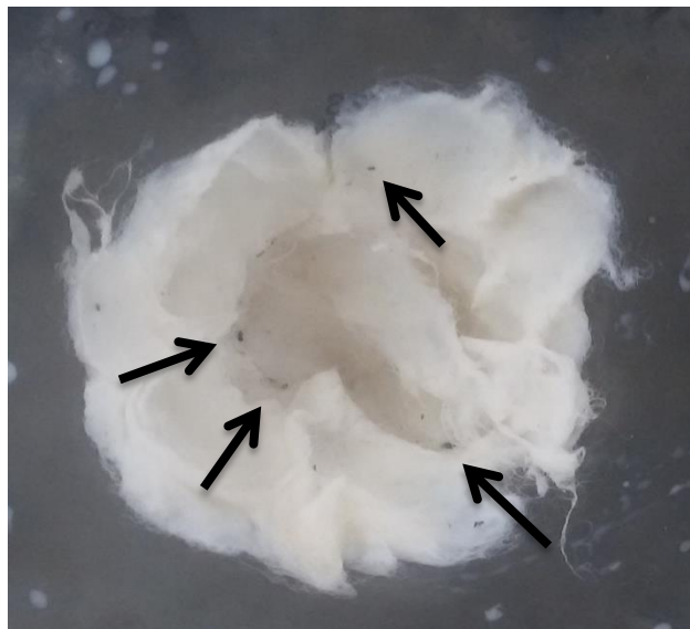
Figura 18: Foto do algodão após a filtragem da emulsão
