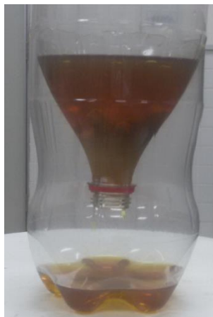
Figura 16: Foto do filtro em processo de filtração do óleo LUBRAX UTILE PE
