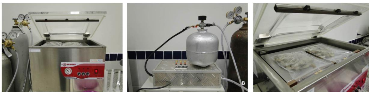
Figura 6: A) Embaladora Sulpack® Supervac B) Módulo compressor e misturador de gases; C) Amostras embaladas. Fonte: Arquivo pessoal.
