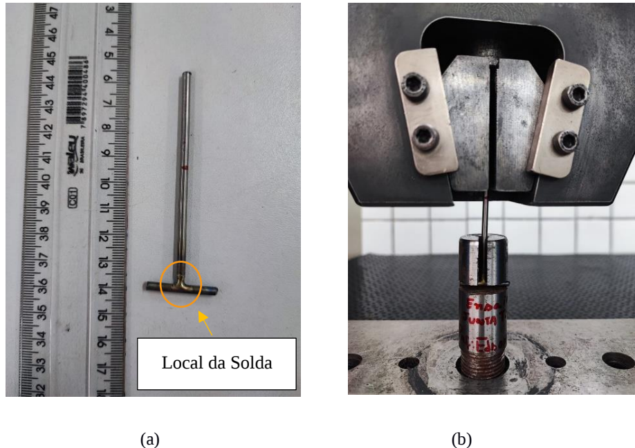
Figura 2: Corpo de prova em escala; corpo de prova com comprimento útil na máquina de ensaio.
