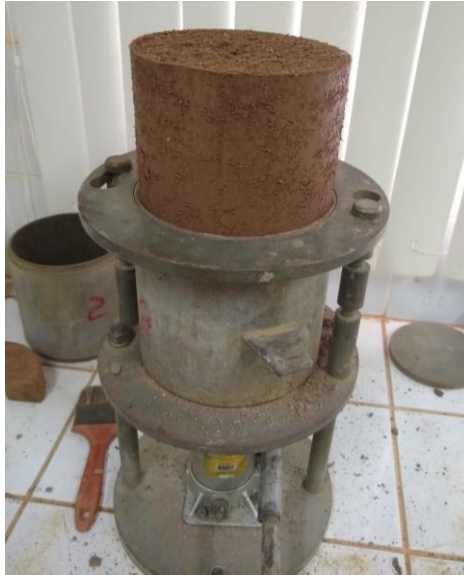
Figura 4- Ensaio de compactação
