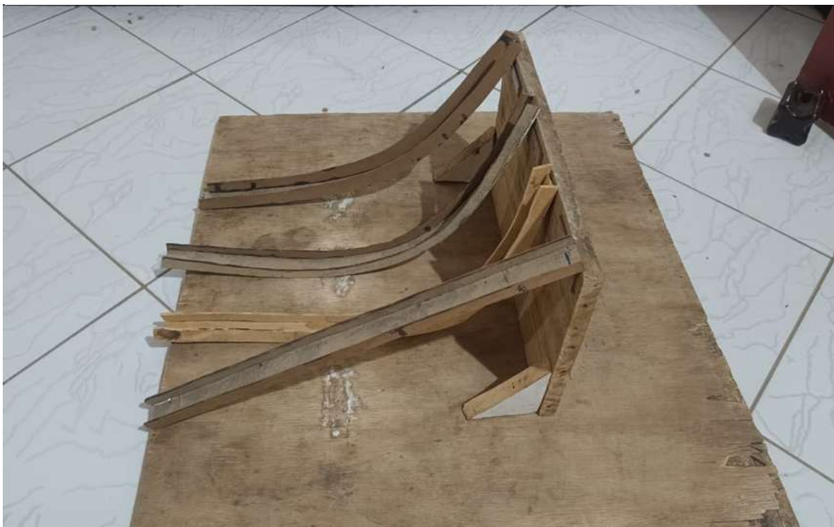
Figura 9 - Vista lateral do aparato experimental finalizado com os quatro tipos de rampas
