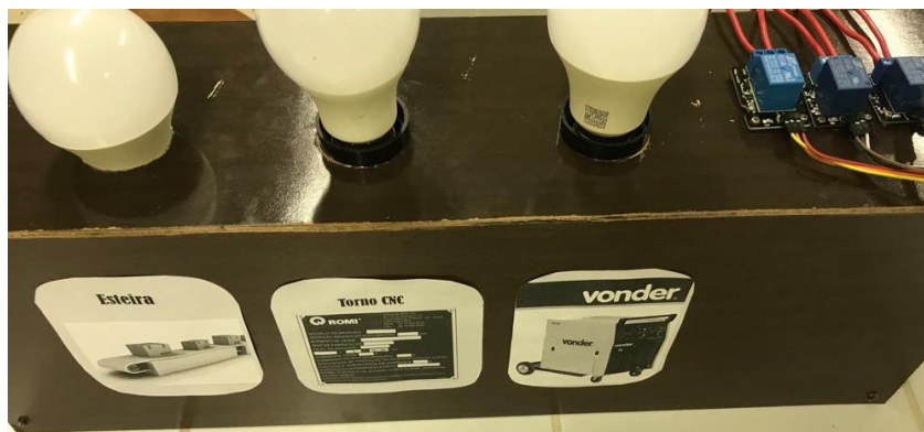
Figura 19. Suporte para teste de máquinas elétricas. (Autoria própria)
