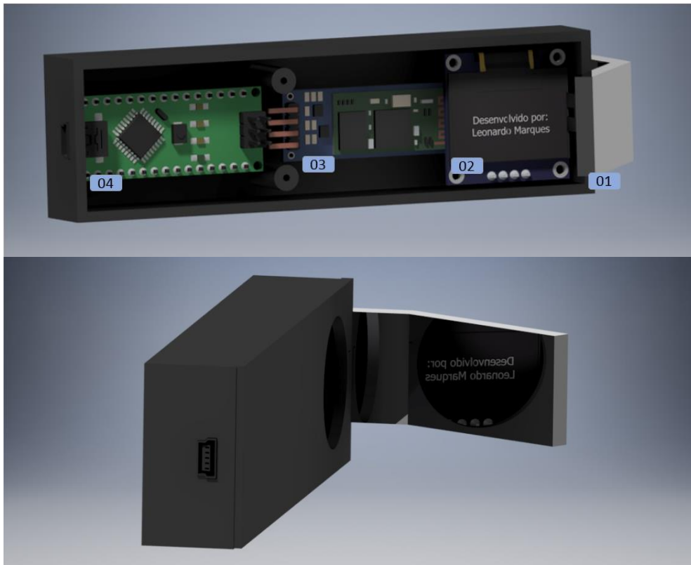
Figura 13. Primeiro protótipo do acoplador. (02 – [21]; 03 – [22]; 04 – [23]; Autoria própria)
