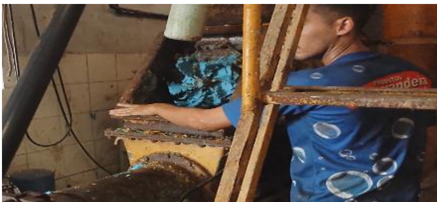
Figura 25 - Processo de extrusão sem proteção
