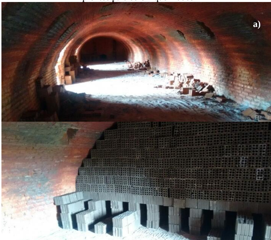
Figura 10: (a) Forno utilizados para a queima de blocos cerâmicos (b) Tijolos prontos para serem queimados
