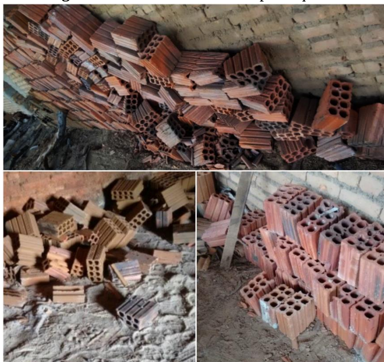
Figura 24: Blocos danificados após a queima
