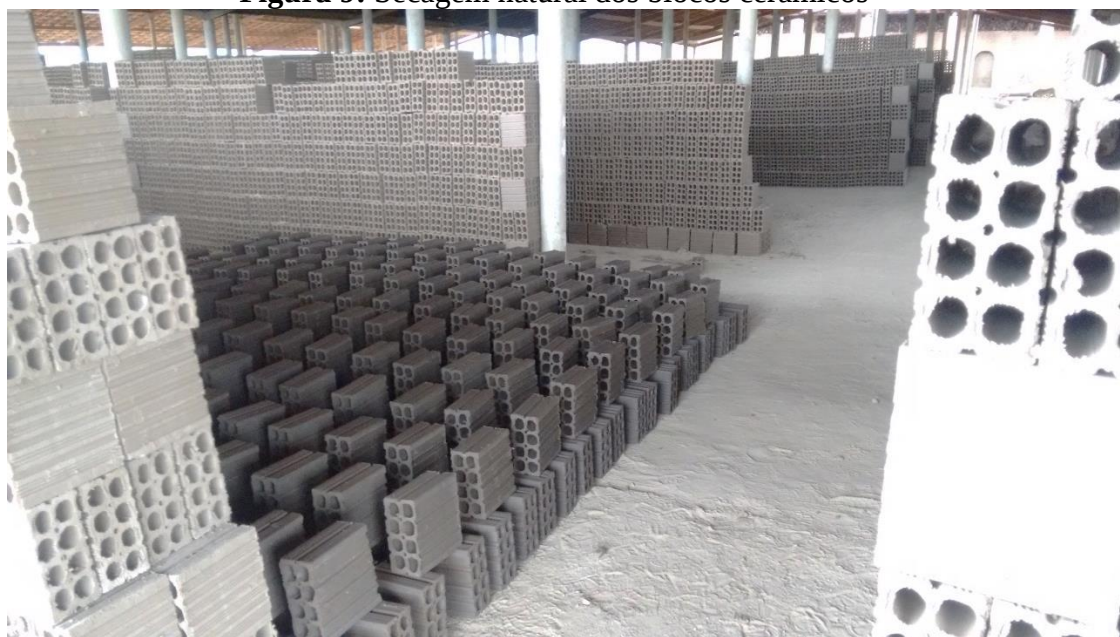
Figura 9: Secagem natural dos blocos cerâmicos
