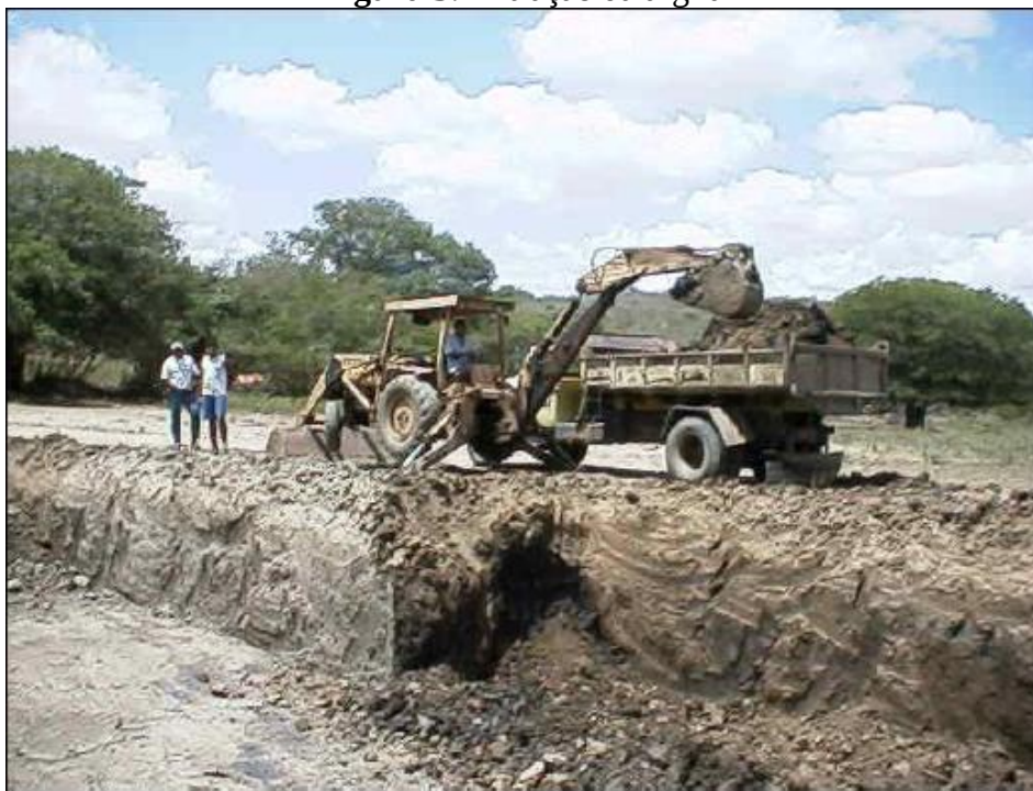
Figura 3: Extração da argila
