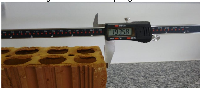
Figura 17: Ensaio medições geométricas
