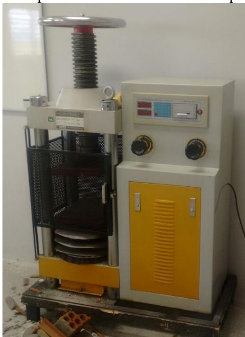
Figura 21: Prensa para medir a resistência à compressão
