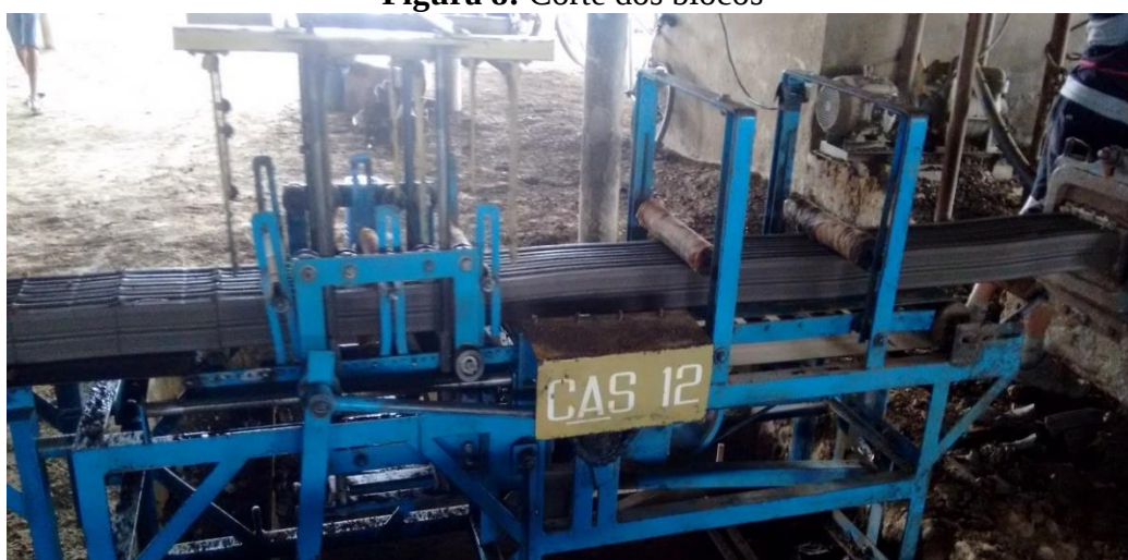
Figura 8: Corte dos blocos
