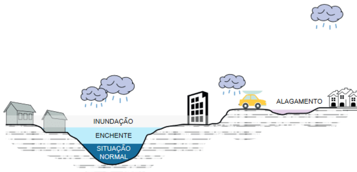
Figura 01 – Representação dos fenômenos: enchente, inundação e alagamento.
