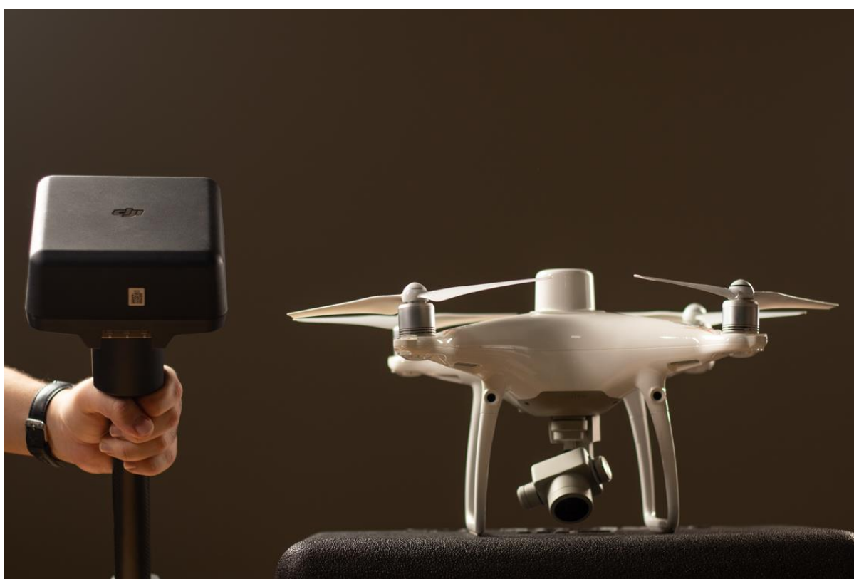
Figura 08 - ARP Phantom 4 PRO RTK utilizada para realizar o aerolevantamento.
