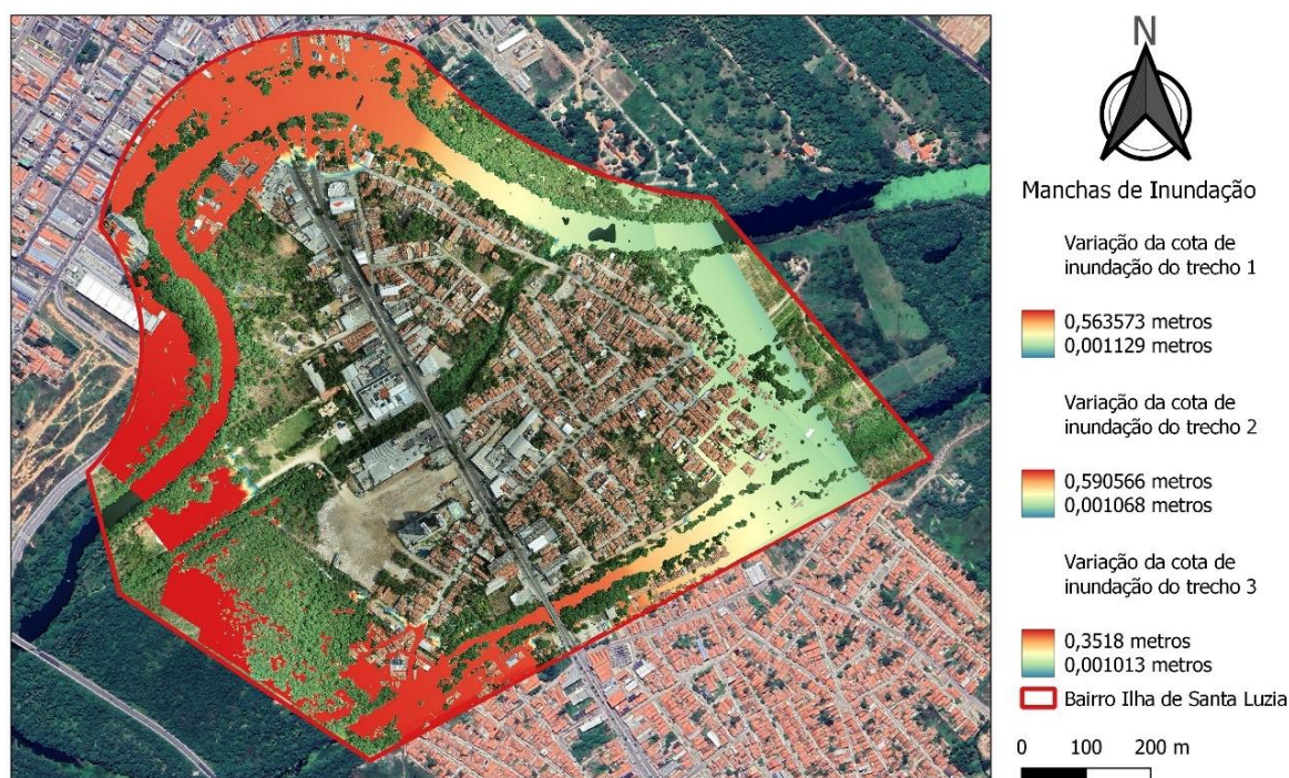
Figura 16 - Manchas de inundação geradas pelo software HEC-RAS.
