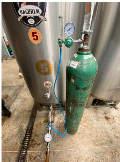
Figura 8 – Mosto e gás oxigênio sendo inseridos no fermentador
