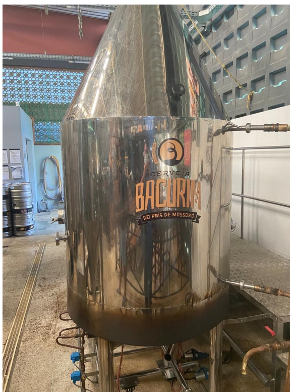
Figura 6 – Tanque de Fervura da Cervejaria Bacurim
