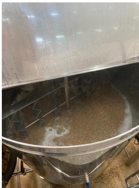
Figura 5 – Tanque de filtragem sob recirculação
