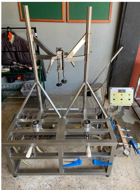
Figura 11 – Máquina de lavar barris
