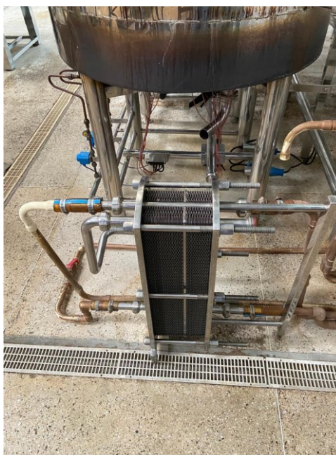
Figura 7 – Trocador de Calor da Cervejaria
