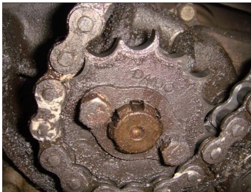
Figura 18: desgaste de transmissão por corrente
