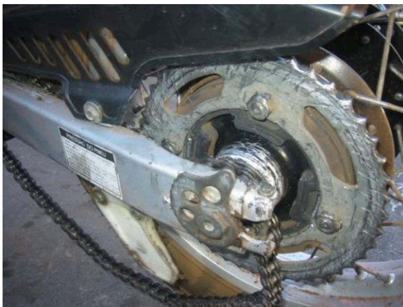
Figura 19: desgaste de transmissão por corrente
