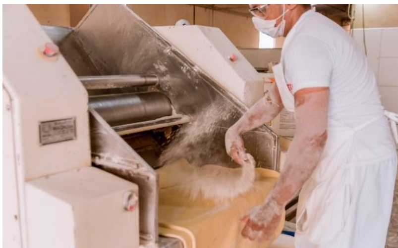
Figura 7. Processo de amassamento na produção de massas na Indústria de Massas Jucurutu, no município de Jucurutu, RN.
