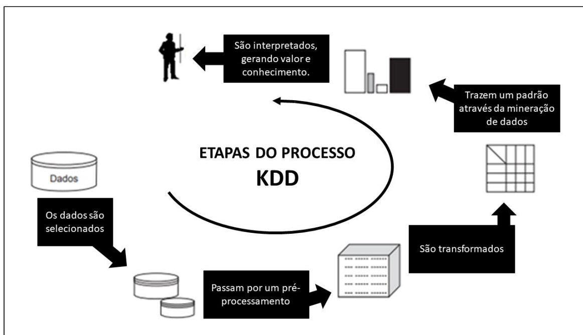
Figura 5. Etapas do processo KDD. Adaptado de [26] (2006).
