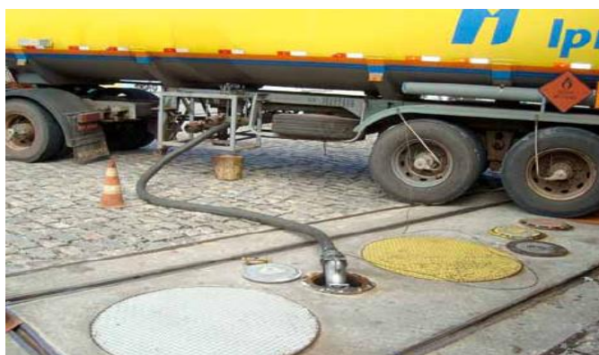
Figura 8 - Mangueira com Joelho de engate rápido para descarga selada.
