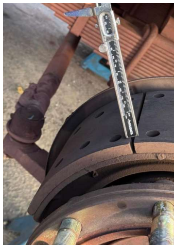
Figura 11 - Medição das lonas de freio
