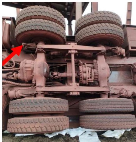
Figura 7 – Atuadores do Sistema de frenagem
