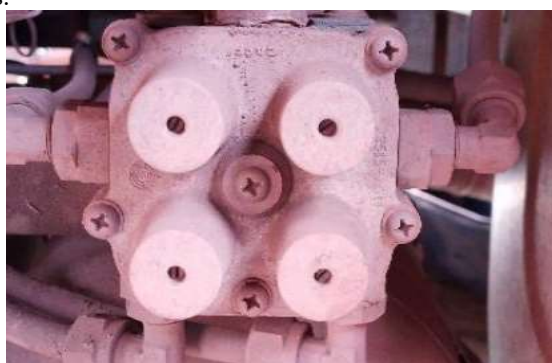
Figura 4 - Válvula de quatro estágios
