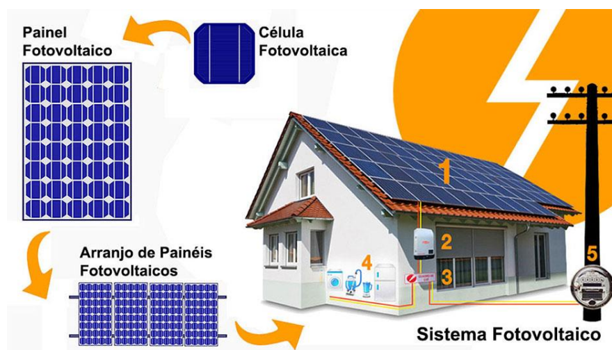
Figura 11 – Composição do sistema fotovoltaico.
