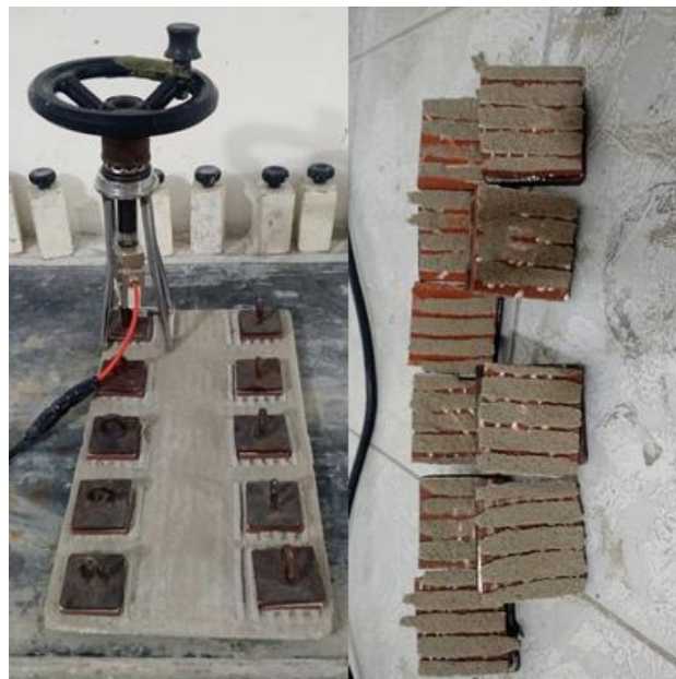
Figura 7- Teste de Arrancamento
