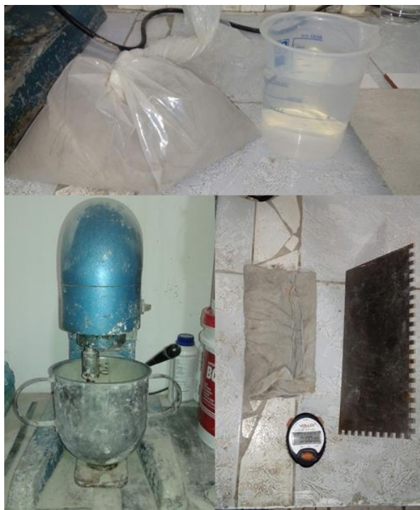
Figura 2- Materiais e equipamentos utilizados na preparação da argamassa
