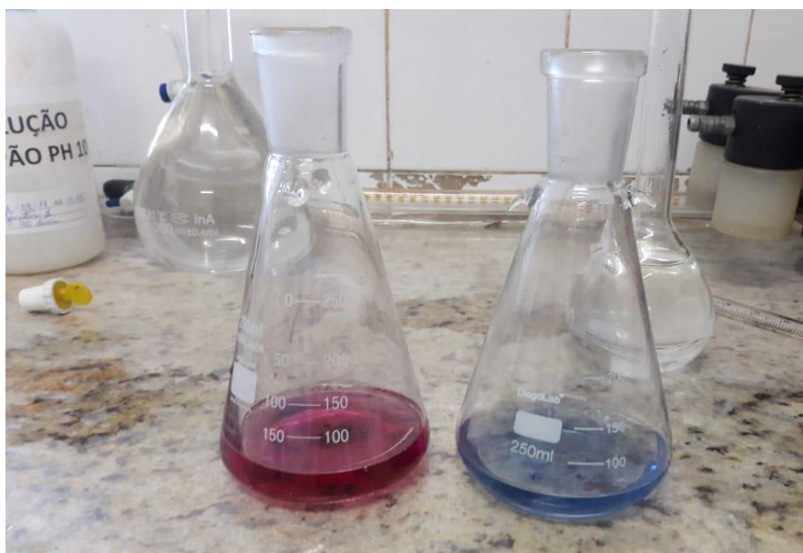
Figura 13 – Amostras para determinação de cálcio e magnésio antes (rosa) e depois de titulados (azul).
