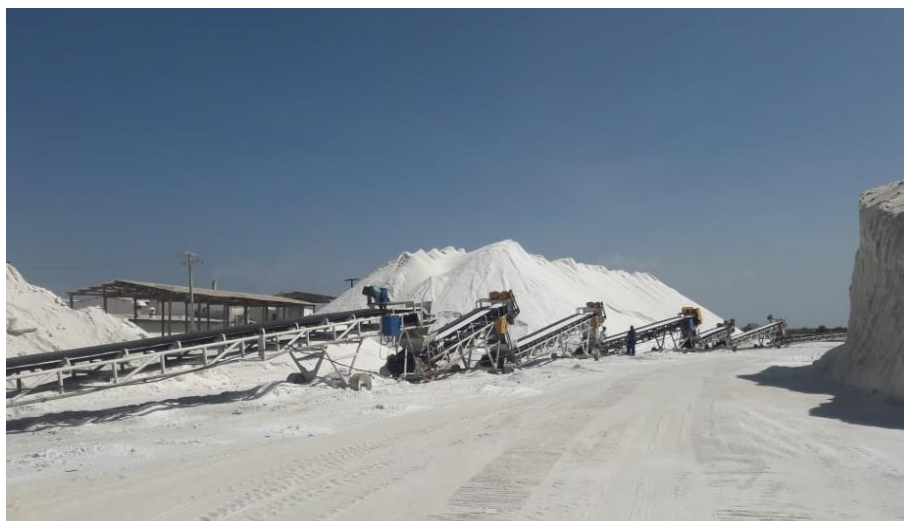
Figura 11 – Esteiras carregando sal para estocagem.
