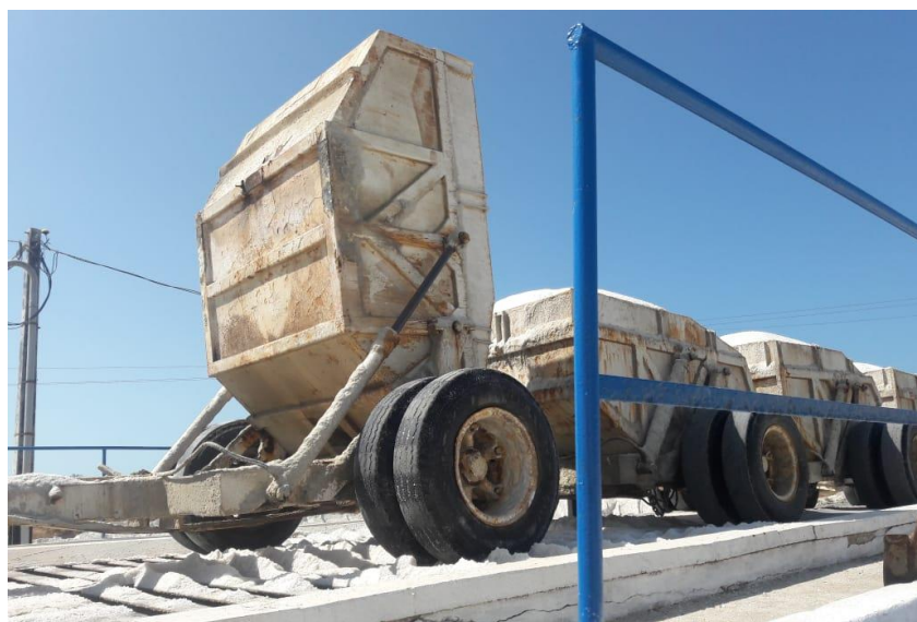
Figura 8 – kibrás despejando sal bruto para lavagem.
