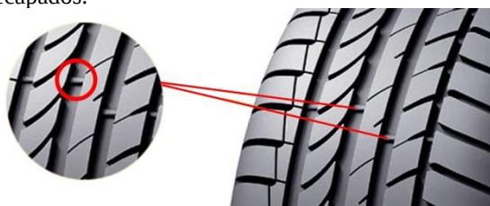
Figura 9: Indicador de desgaste (TWI). Fonte: Vivento Segurança.
