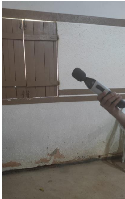
Figura 39- Medição com o sonômetro nos pontos
