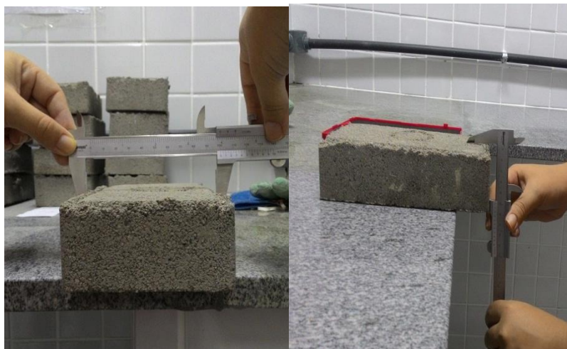
Figura 20: Medição das dimensões do bloco com o paquímetro.
