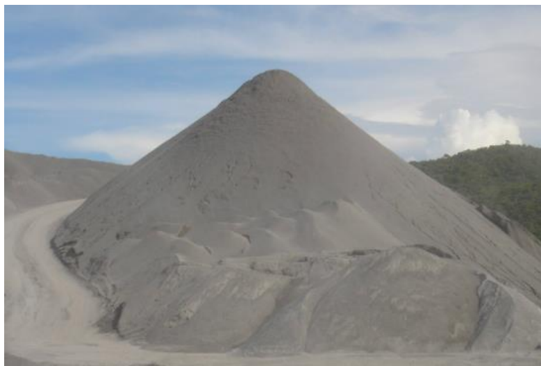
Figura 8: Armazenamento do pó de pedra na Pedreira Potiguar.
