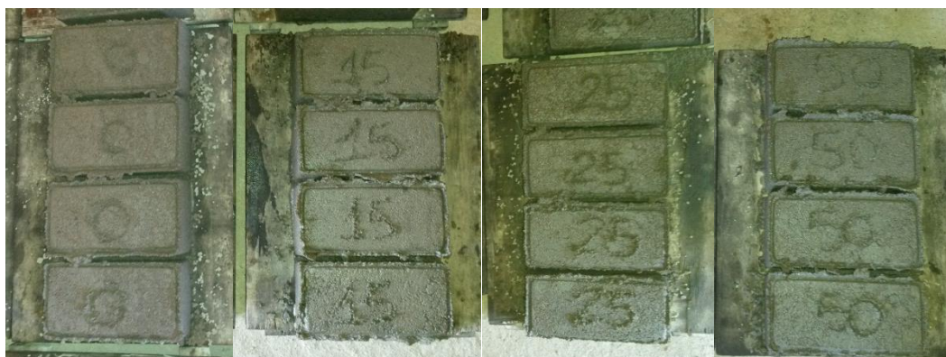
Figura 17: Blocos intertravados produzidos de (0%, 15%, 25% e 50 % de pó de pedra).
