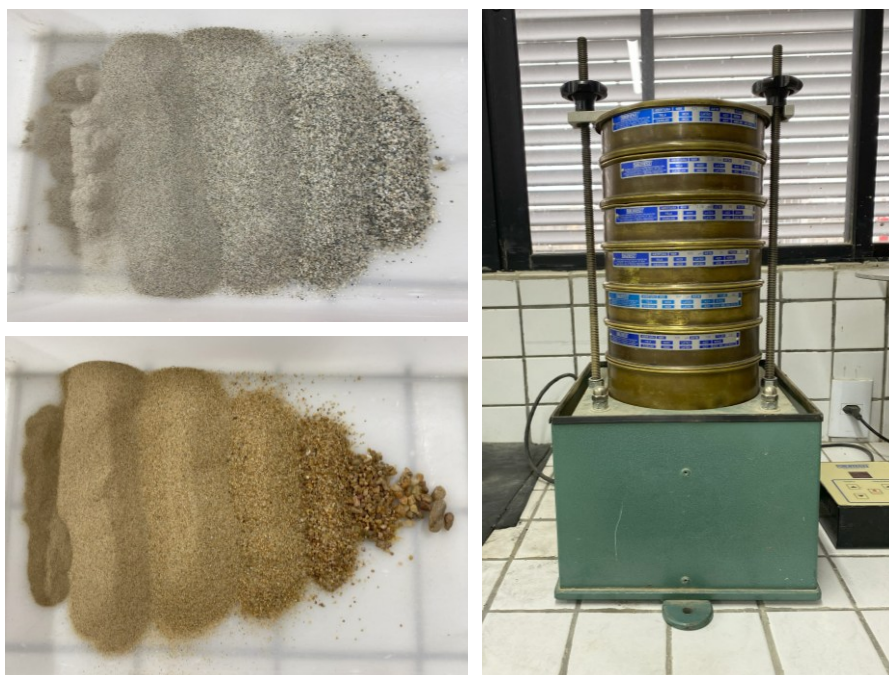
Figura 10 – Ensaio de determinação da composição granulométrica
