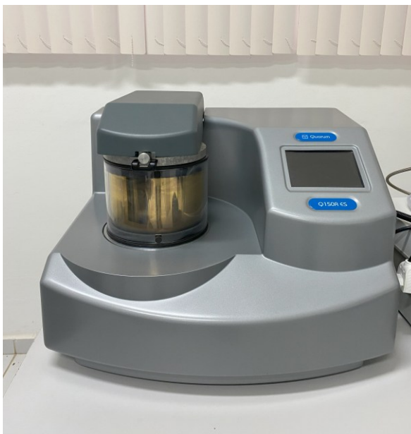
Figura 13 – Equipamento que realiza o processo de metalização
