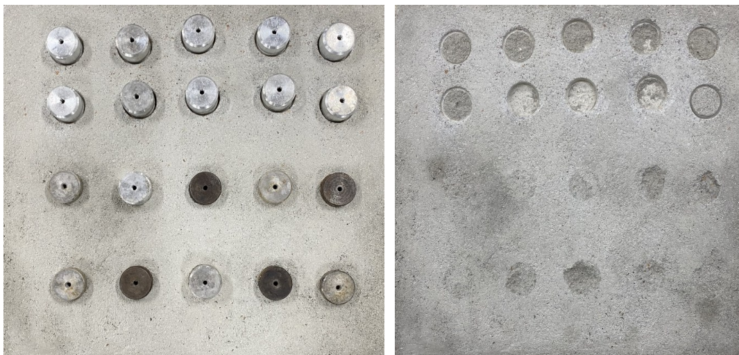
Figura 19 – Ensaio de resistência potencial de aderência à tração ao substrato e superficial
