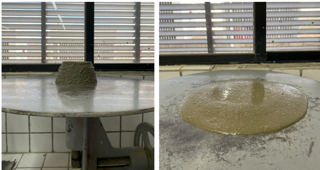
Figura 15 – Realização de ensaio para determinação do índice de consistência
