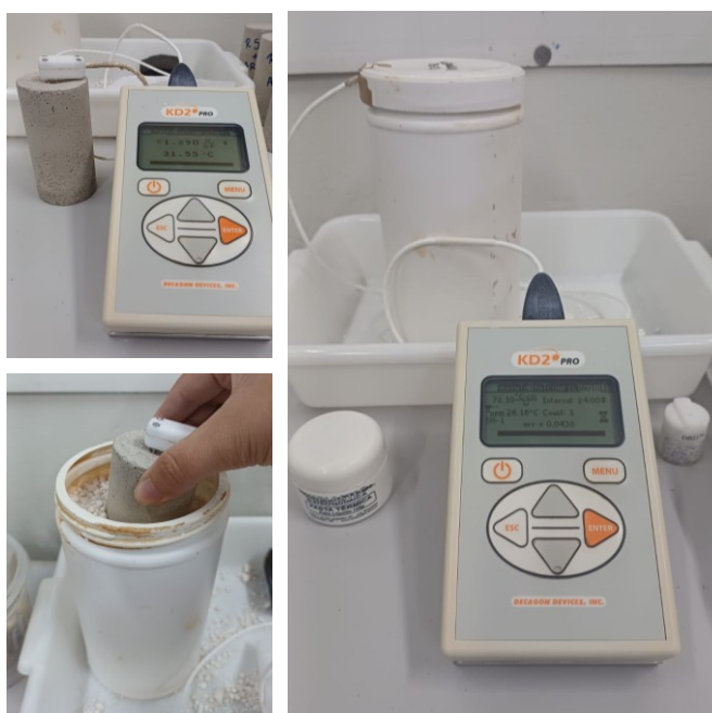
Figura 21 – Ensaio térmico com o equipamento KD2 Pro Thermal Analyzer
