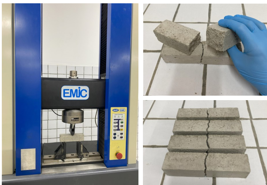
Figura 18 – Ensaio de resistência à tração na flexão
