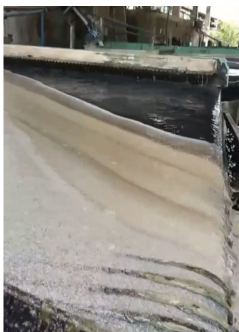
Figura 4 – Separação do granulado, misto e resíduo na mesa vibratória
