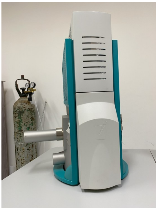
Figura 14 – Microscópio Tescan Vega 3 LMU (República Tcheca) realizando o ensaio de microscopia eletrônica de varredura (MEV)
