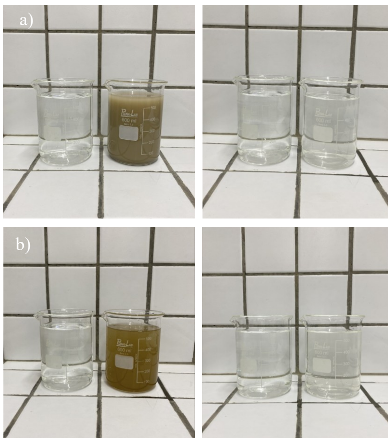
Figura 11 – Determinação do material fino que passa pela peneira de 75 \mu\text{m} por lavagem: resíduo de scheelita grosso (a) e areia quartzosa (b)
