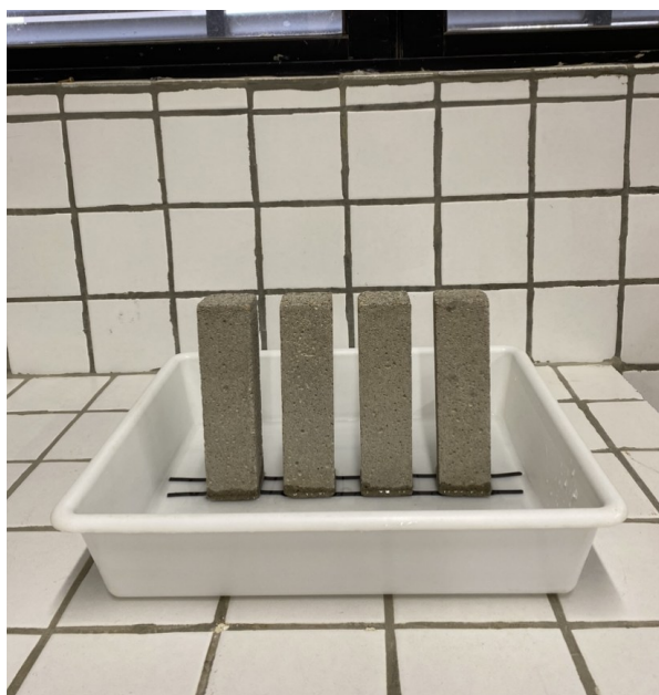
Figura 17 – Ensaio de absorção de água por capilaridade
