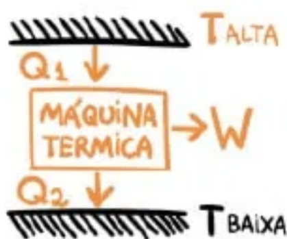
Figura 19 - Esquema de funcionamento de uma máquina térmica
