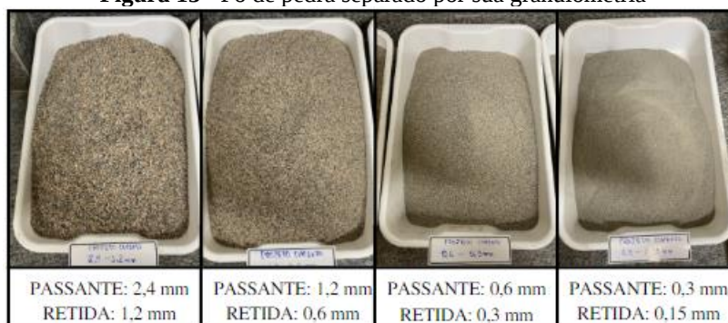
Figura 13 - Pó de pedra separado por sua granulometria
