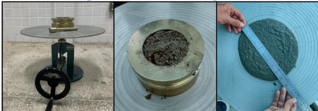
Figura 18 - Ensaio de consistência das argamassas
