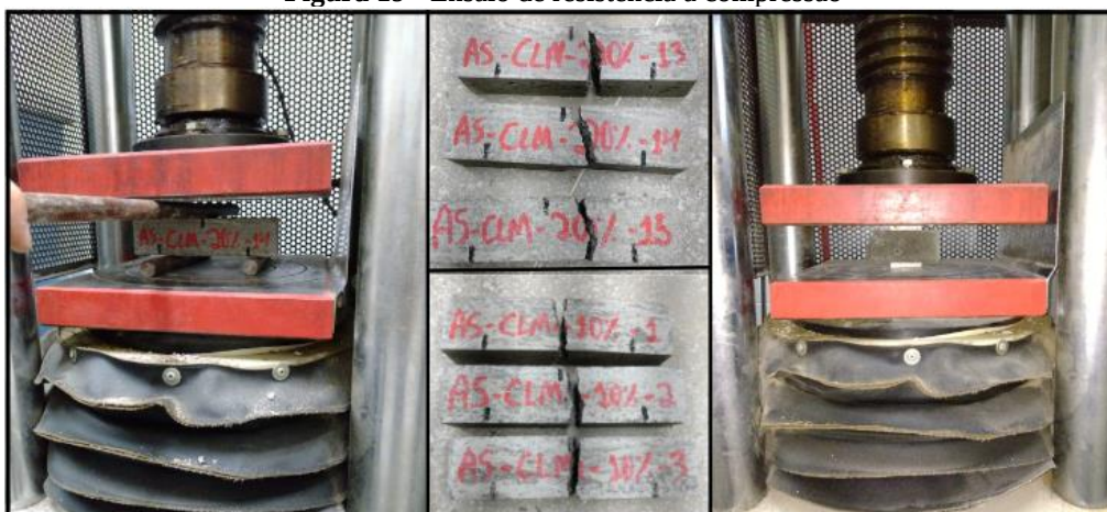
Figura 19 - Ensaio de resistência à compressão
