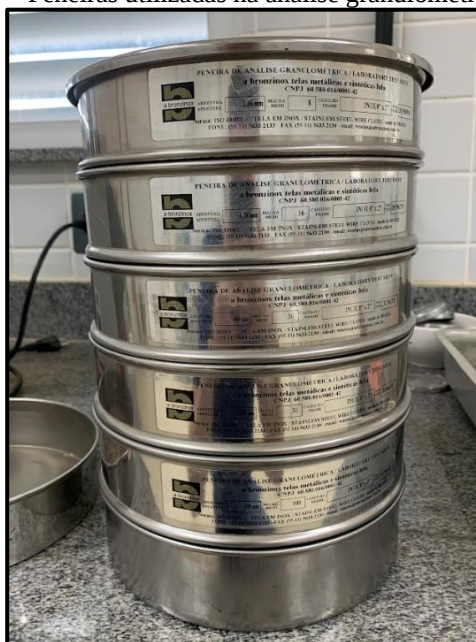
Figura 14 - Peneiras utilizadas na análise granulométrica
