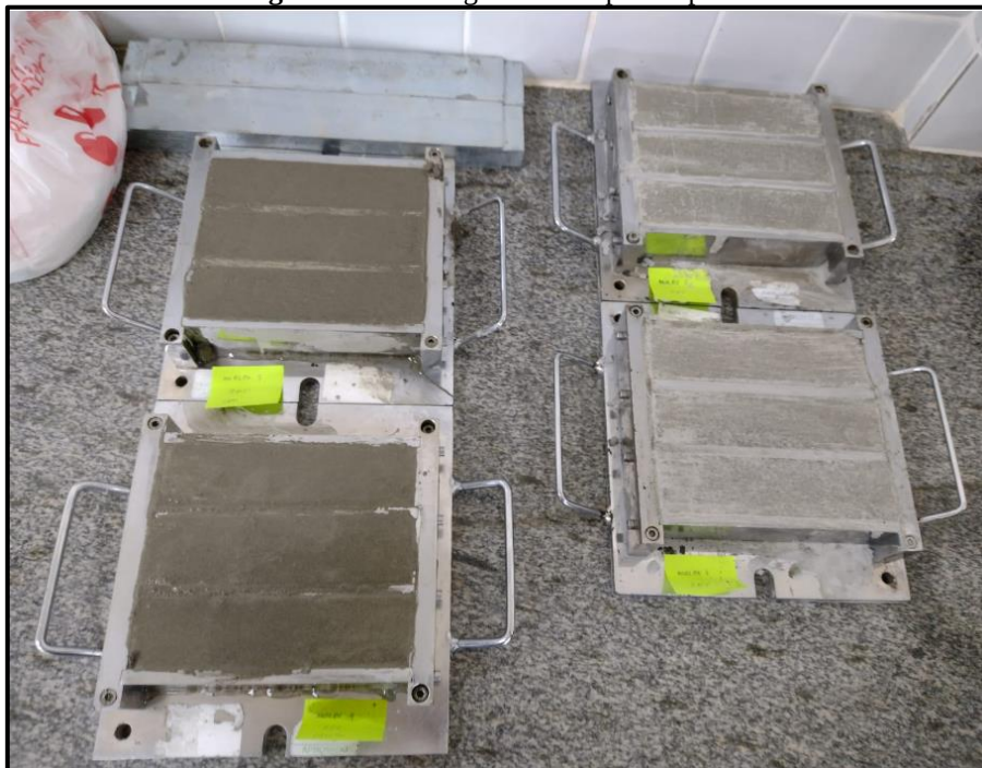
Figura 16 - Moldagem dos corpos de prova
