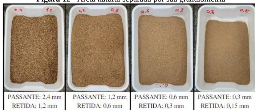
Figura 12 - Areia natural separada por sua granulometria
