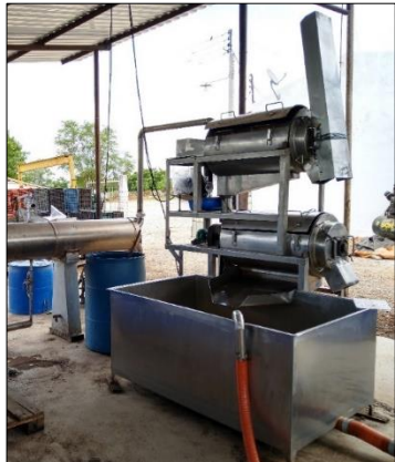
Figura 4: Despolpadeira de goiabas
