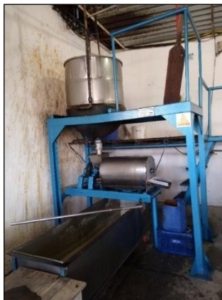
Figura 6: Despolpadeira de bananas e caju
