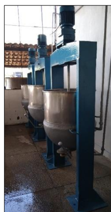
Figura 14: Bateria de 3 tachos de cocção de doce de leite
