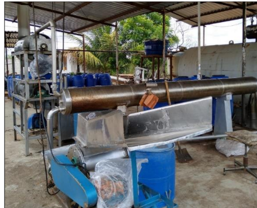
Figura 5: Despolpadeira de goiabas
