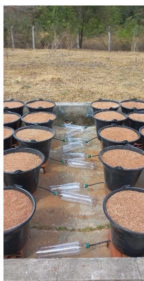
Figura 5 – Drenos instalados nos vasos para coleta de lixiviado.
