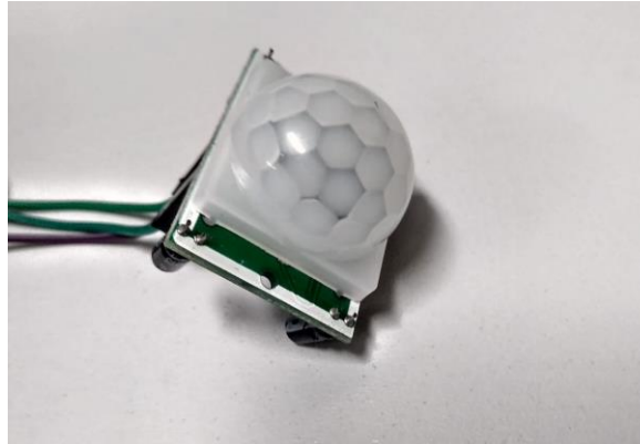
Figura 9: Sensor de presença PIR DYP-ME003
