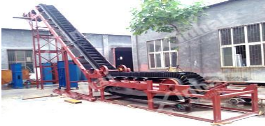
FIGURA 12: Transportador de correia de alta inclinação
