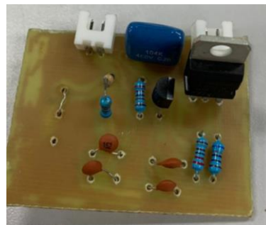
Figura 23 - Circuito oscilador de 30 kHz.
