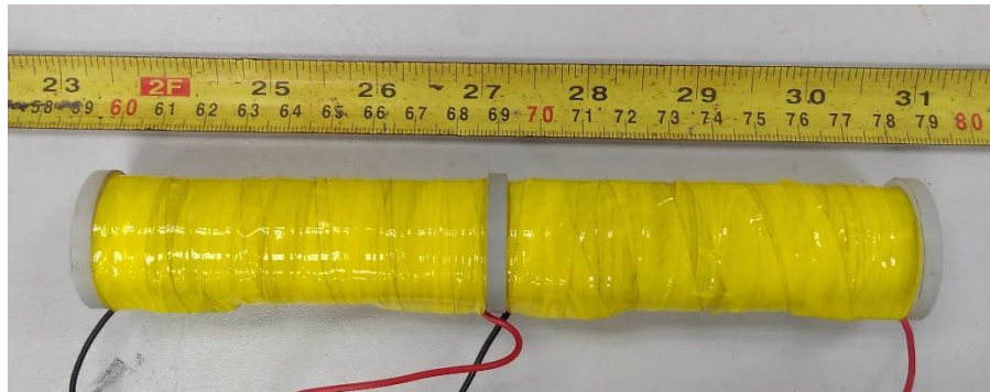
Figura 18 - Resultado do enrolamento das bobinas do secundário.
