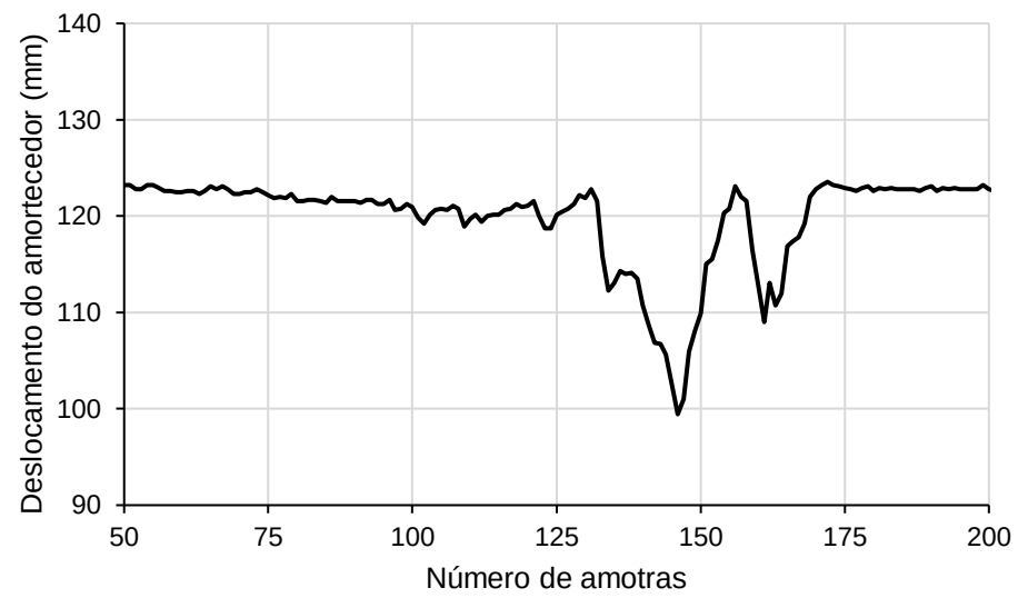
Figura 37 - Dados da aquisição do Baja transpondo uma manilha.
