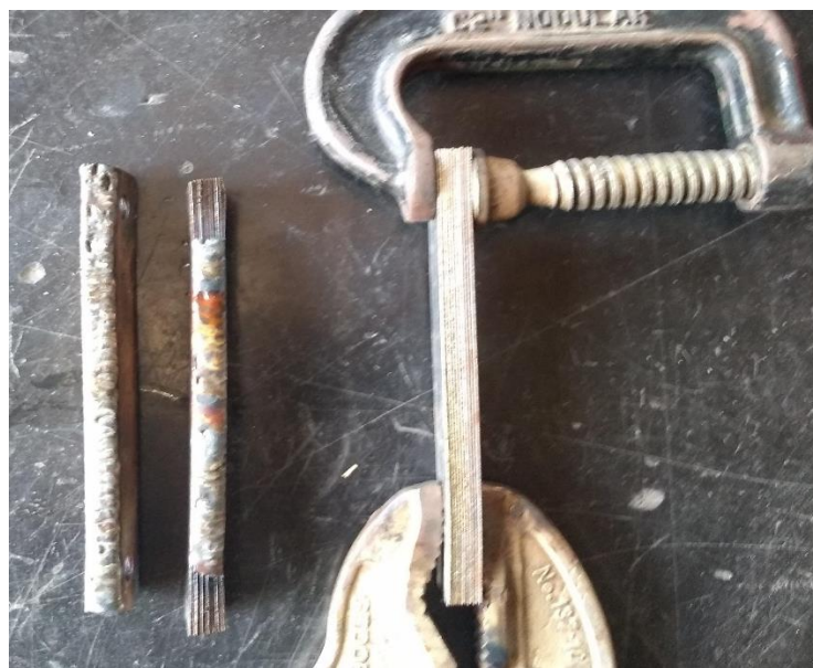
Figura 13 - Processo de soldagem das chapas de ferrosilício.
