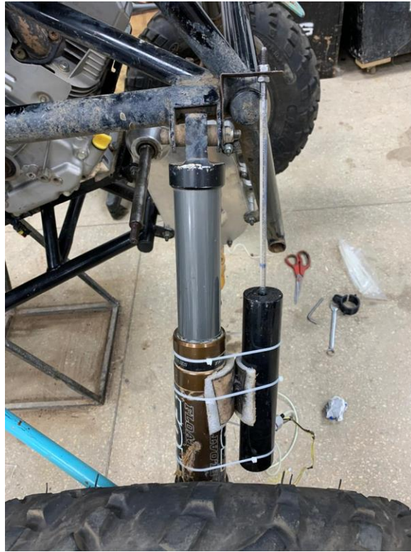
Figura 31 - Vista lateral da montagem do LVDT no amortecedor traseiro.
