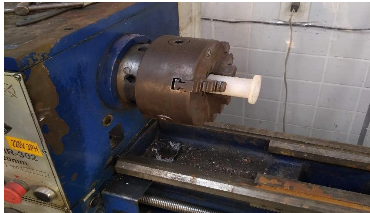
Figura 11 - Início da usinagem do carretel.
