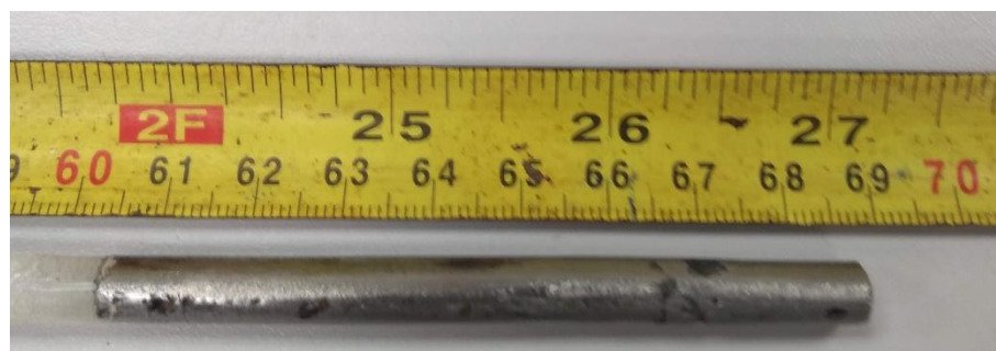
Figura 14 - Núcleo feito de chapas de ferrosilício.
