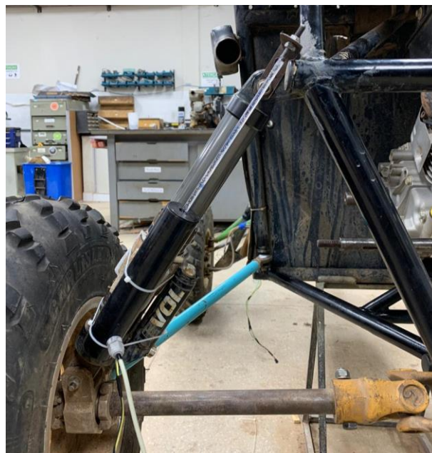
Figura 30 - Vista frontal da montagem do LVDT no amortecedor traseiro.
