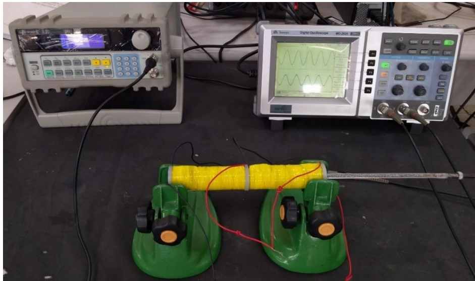
Figura 20 - Montagem experimental da varredura de frequência.
