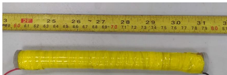
Figura 17 - Resultado do enrolamento da bobina do primário.
