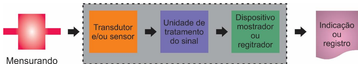
Figura 4 - Módulos funcionais de um sistema de medição.
