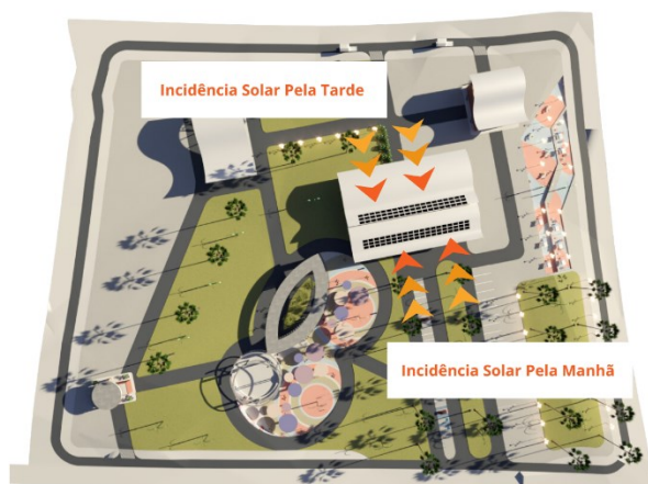
Figura 59 - Posicionamento das Placas Fotovoltaicas
