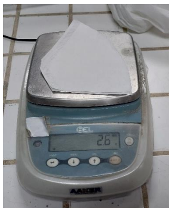
Figura 18 – Pesagem dos filtros de papel secos.
