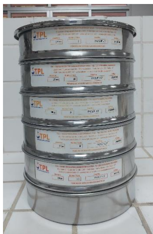
Figura 21 - Peneiras utilizadas no ensaio de granulometria.
