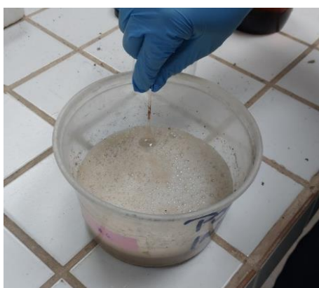
Figura 16 – a) e b) Reação de efervescência da argamassa após aplicação do ácido clorídrico.
