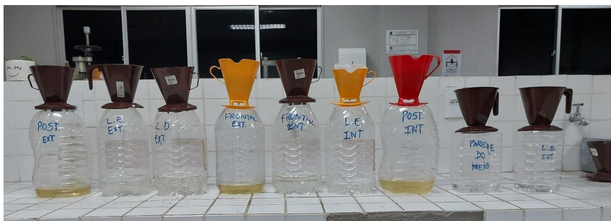
Figura 19 – Processo de filtração da argamassa para remoção do ácido clorídrico.
