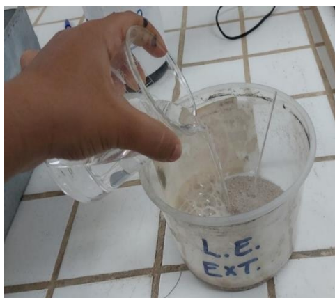
Figura 15 – Adição de ácido clorídrico nas amostras.
