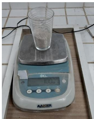
Figura 14 – Pesagem das amostras de argamassas destorroadas.
