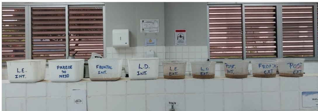
Figura 17 – Amostras em repouso por 24h após aplicação do ácido.
