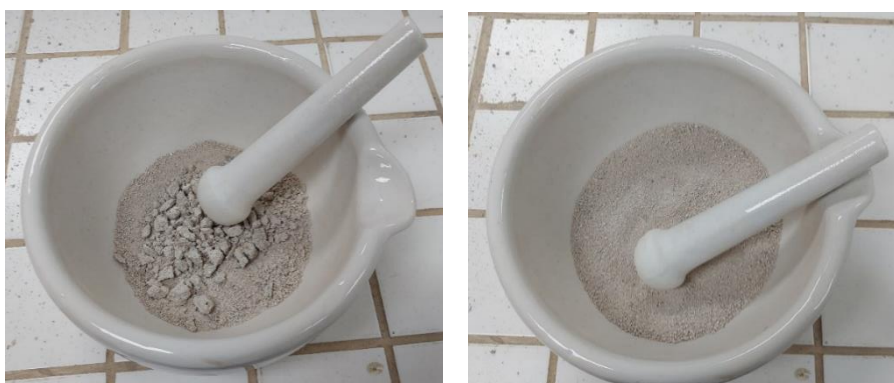
Figura 11 - a) Início do processo de destorroamento; b) Amostras destorroadas com o almofariz de porcelana.
