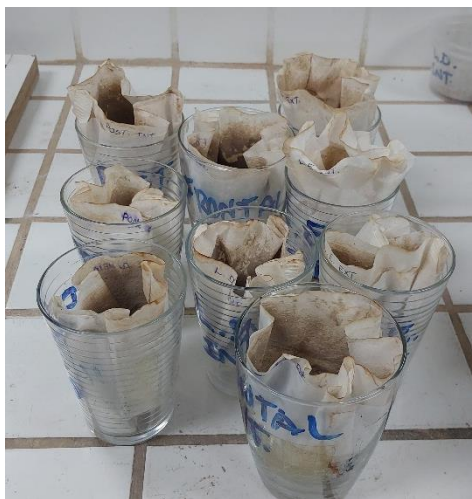
Figura 20 – Amostras drenadas após 24h em estufa.
