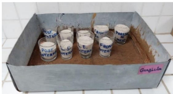
Figura 12 – Amostras destorroadas, separadas e rotuladas
