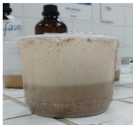
Figura 16 – a) e b) Reação de efervescência da argamassa após aplicação do ácido clorídrico.
