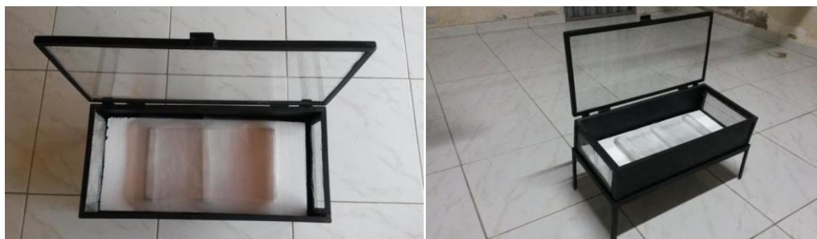
Figura 2. Secador solar de exposição direta. [6], [7] e [8]
