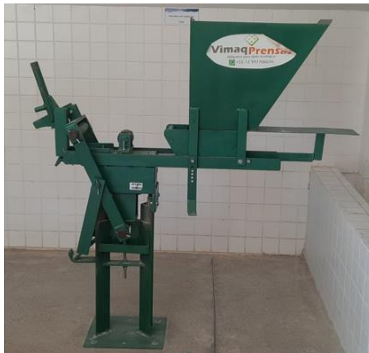
Figura 01 - Prensa manual utilizada na confecção dos tijolos.
