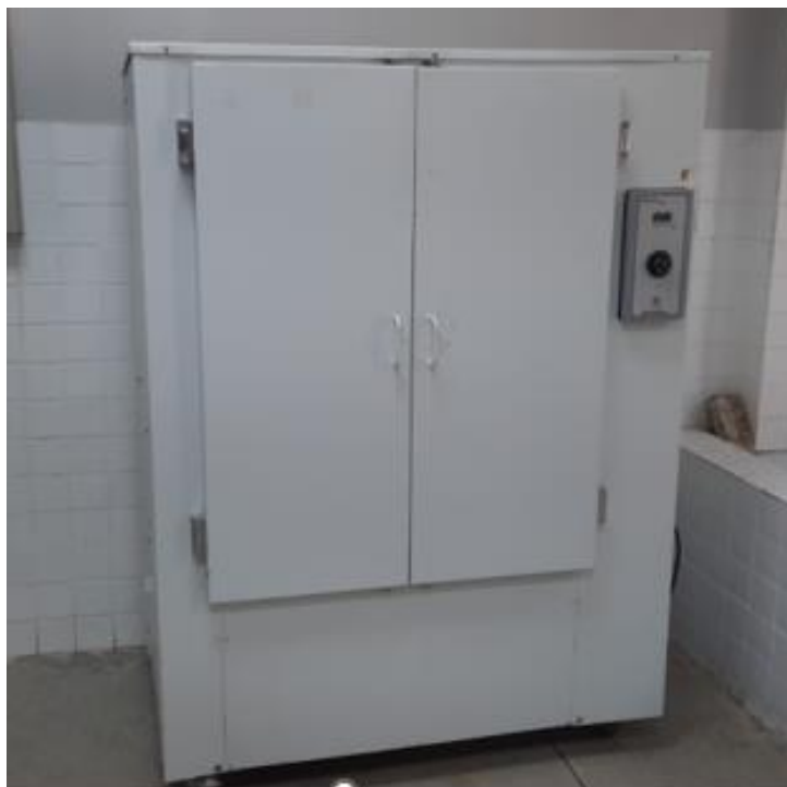
Figura 04 – Estufa para secagem dos blocos.
