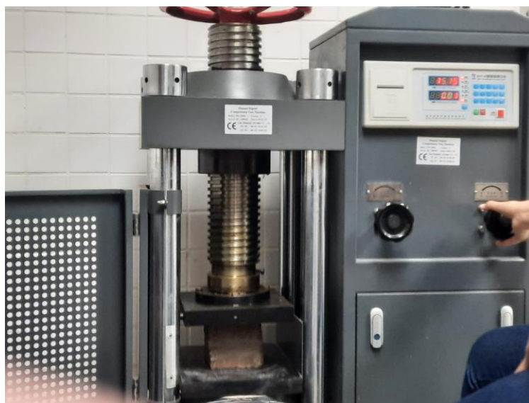
Figura 05 - Máquina do ensaio de resistência à compressão.
