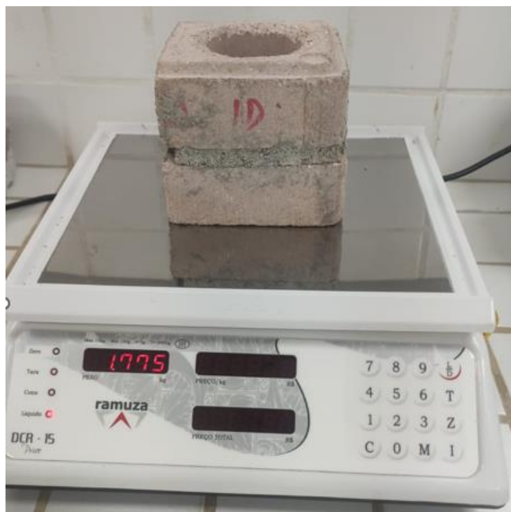
Figura 06 – Pesagem dos corpos de prova na balança digital.
