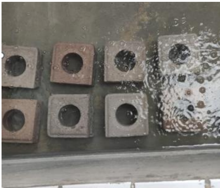
Figura 03 - Tanque d'água com os corpos de prova durante o ensaio de absorção.
