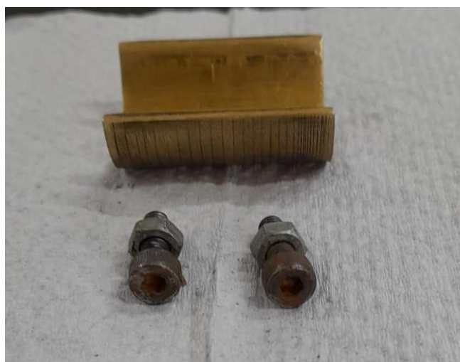
Figura 30 – Esbarro de Latão e Parafusos
