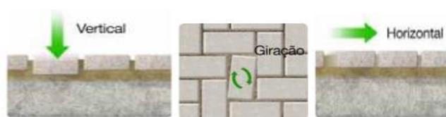
Figura 6 - Detalhes de descolamentos
